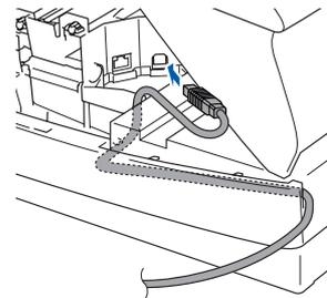
3. 如下图所示，小心地将 USB 电缆插入电缆槽内，并顺着电缆槽绕到本设备后部。
